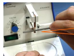
平状の精密ヤスリを水平にあてて上下電極の先端面を磨く
