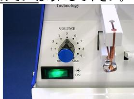
⑤加工スイッチのピンを押し下げると、ピッと音が鳴り、上下電極にて挟んだ点で溶接が行われます。加工は一瞬で自動的に終了し、その後待機状態となります。
