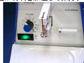
④VOLUME を設定します。右方向へ回すほど加工エネルギーは強くなります。初めて扱う被溶接材の加工時には、必ずVOLUME を MIN の値から徐々に上げていくことで最適なVOLUME 値を求めていくようにして下さい。
