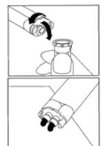
③ミキサーチップをシリンジの溝に合わせて奥まで押し込み、時計回りに1/4回転させて装着します。
