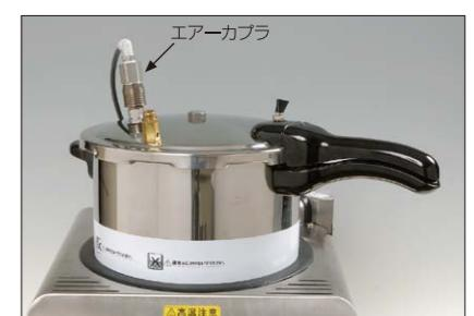
②エーカーブラをエアーリンクバルブに接続し、重合開始ボタンを1秒間長押しして重合モードをスタートさせます。
