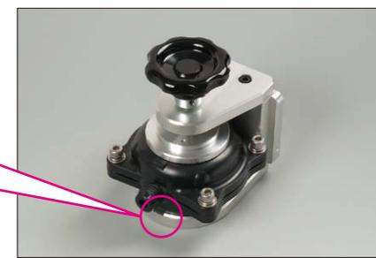
③ フラスコをセットしたフラスコ固定器を、フィットレジン インジェクター本体に戻し、手前のストッパーの位置にセットします。
