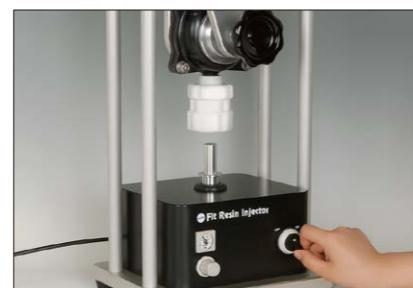
②シャフトが降下したのを確認した後、フラスコ固定器を手前にスライドさせて、フィットレジン インジェクター本体から取り外します。
