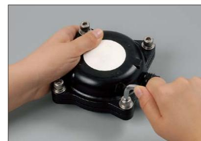
② フラスコ固定器に、ボルトを外したフラスコをセットします。
