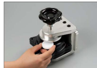
③ フラスコ側面部の隙間に開閉治具A・Bの柄部を挿入します。
