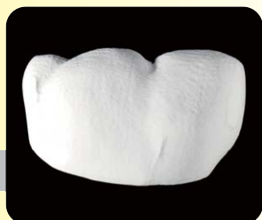
加工直後 (表面粗さ: 0.731 \mu m)
