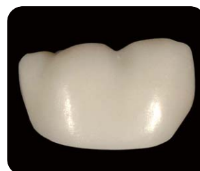
焼結後(表面粗さ: 0.246 \mu m)
