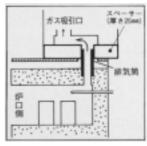
c.排気筒の外径が 17 mm より小さく、右図のような構造の電気炉の場合は、炉外の空気を吸引することになるために、キャスティングリボン等を排気筒に巻き、シールして下さい。
