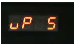
上側のリミットスイッチが 押されている
