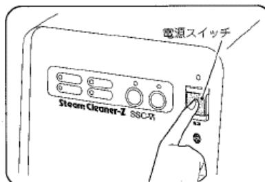
3. 排蒸スイッチを押しながら電源スイッチを「ON」にしてください。
