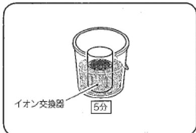
7. イオン交換器を取り出し、3L以上の流水をイオン交換器に通してください。
