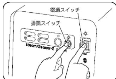
6. ポンプの運転音が止まつたら電源スイッチを「OFF」にしてください（排水コックA・Bは閉めたままにしておいてください）。
