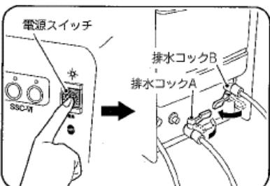
6. 電源スイッチを「OFF」にし、排水コックA・Bを閉めてください。
