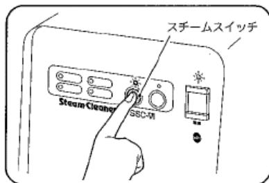
3. ポンプの運転音が停止したらスチームスイッチを「OFF」にしてください。
