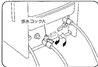
13. 排水ホース（白）からスケール混じりの水が出なくなるまで、手順12の排水コックA（赤）の開閉作業を数回繰り返してください。
