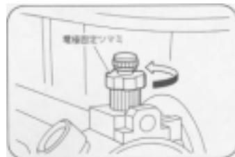
②付属のアークゲージを使い、金属表面と電極先端との間隔（約5mm）を調整してください。電極は電極調節ツマミを回すと上下します。
