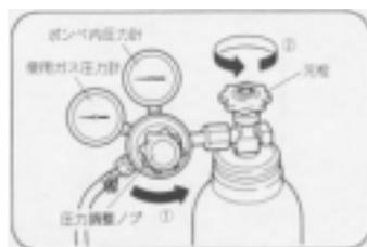
③圧力調整ノブを右にゆっくり回し、使用ガス圧を  $3\text{kgf/cm}^2$  (約  $0.3\text{MPa}$ ) に調整してください。
