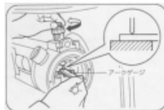
③調整が終われば、電極固定ツマミを締め付けてください。
