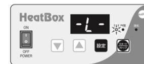
**参考** ・重合室内温度が 40℃ 以下のときは温度/時間表示部に「-L-」と表示します。
