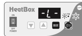
**参考** ・重合室内温度が設定した加熱温度以上のときには、運転を開始できません。重合室内温度が下がるのを待ってください。
