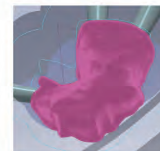
スーパーファインモード加工サイクル内面 全領域を0.6mmツールで細密加工するため、 良好な適合が得られる
