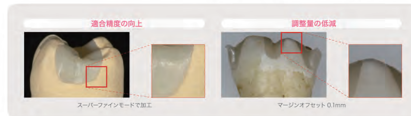
ファインモード加工サイクル内面 0.6mmツールの使用は一部 ※紫部分が0.6mmツールで加工箇所
