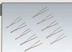
ダブルピン ワイヤーピン 10本 形状:ポスト部15mm(脚部8mm) 全長23mm 太さ:φ0.5mm 変形可能 成分:カンタル合金、最高使用温度:1200℃
