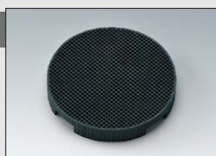
ダークトレイ ポーセレン焼成用トレイ 1個 寸法:φ68×H10mm・メッシュピッチ 1.4mm 成分:炭化ケイ素 99%、最高使用温度:1200℃
