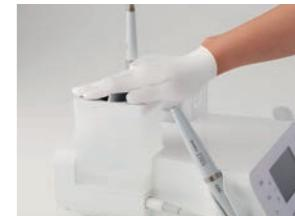
注水タンクの蓋をしっかりと閉め直し、コントロールユニットにまっすぐ挿しこみ戻す。
