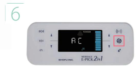
パワー設定「10」、注水量設定「10」にし、パウダーが空の状態でフットコントローラーの「D」ボタンを踏んで空運転(1秒間以上)を5回繰り返す。
