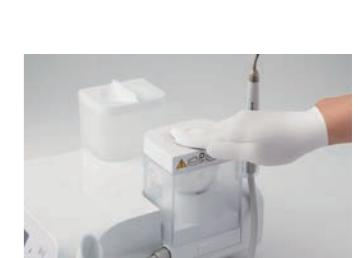
チャンバーの蓋をしっかりと閉め直し、コントロールユニットにまっすぐ挿し込み、戻す。
