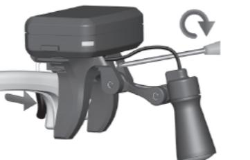
注記 取付ネジはヘッドライトの稼働部からアクセスできます。稼働部はバッテリーパックに対して下方向にのみ回転し、それ以上は動かないように設計されています。上図に示されているよりも下に動かさないでください。
