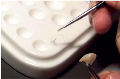
図110 筆のリキッド量は可及的に少ないほうが良い。写真は筆でGP-Fをすくい取っている状態。高い粘稠度が確認できる。
