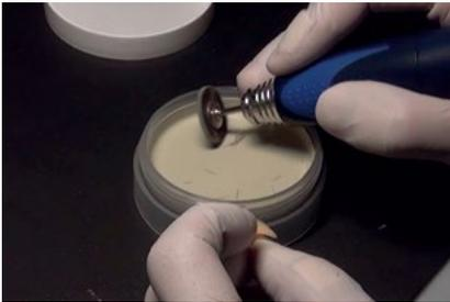
図130 ロビンソンブラシを回転させて、ジルグロスに押し付ける。
