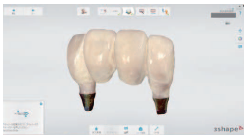
図13 デジタル法では、従来のようなカスタム印象用コーピングの製作は必要ない
